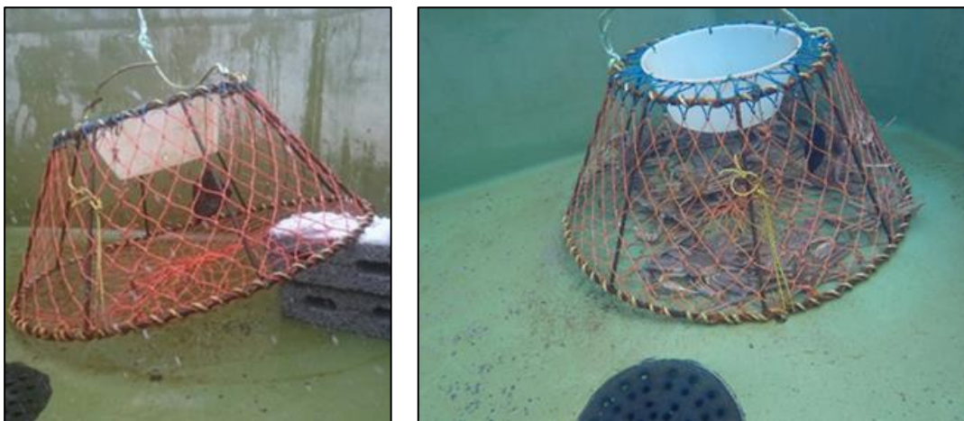
Figur 3 Forsøksoppsett med teiner som er plassert skrått på bunnen (18 °) og i normal posisjon
